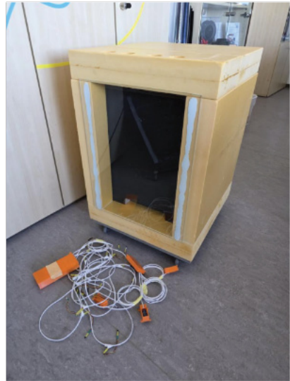
Obr. 1 Model domu s demontovanou sadou čidel a stěnou z černého betonu
