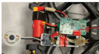
Obr. 1 Modul přimontovaný na dronu Elios 3
