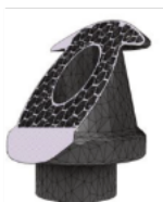
Obr. 1 Vizualizace 3D skenu vytištěné průchodky.
