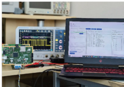
Obr. 1 - Testovací stanoviště, MPU + IO, logování do PC
