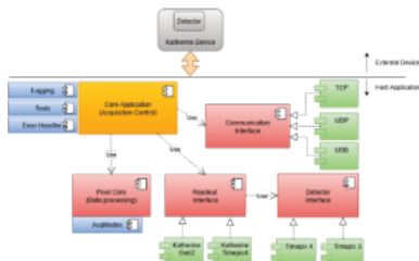
Obr. 2 Modulární architektura akvizičního SW
